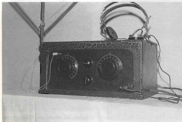
figura 1 - Radioricevitore del 1925/26 (autocostruito). Questo apparecchio è descritto su E.F. n° 9, settembre 1989.
