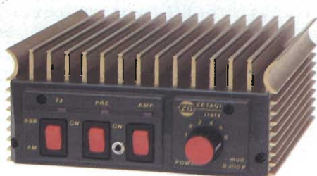
BV 135 - 200 W AM / 400 W SSB - 2 valvole
